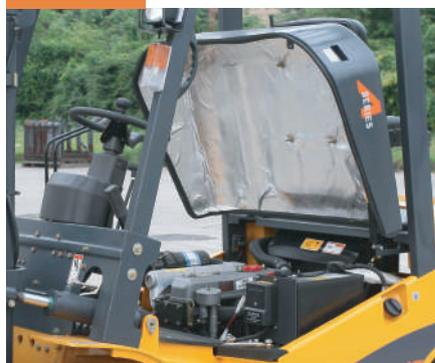
Mayor ángulo de apertura, facilita acceso al motor para trabajos de mantenimiento.
